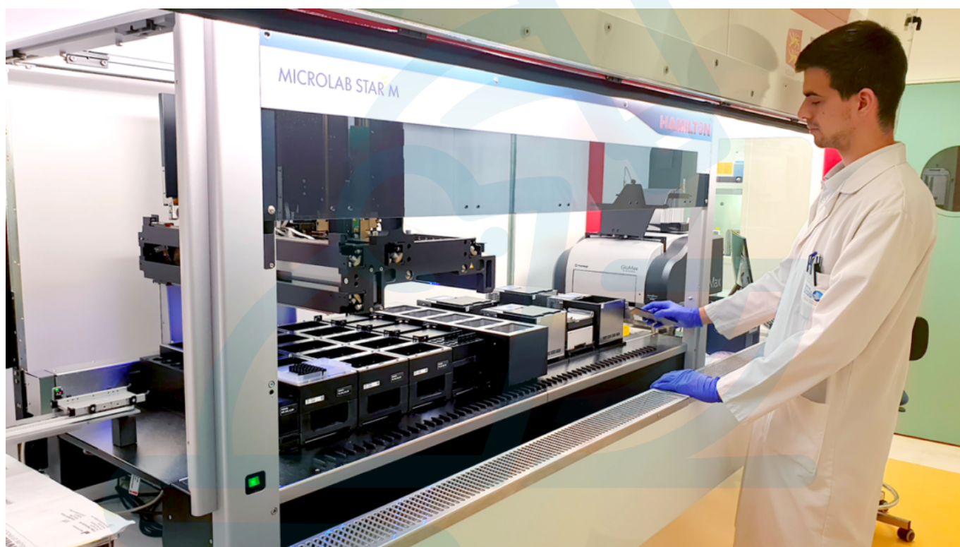
Robot de culture et de traitements de tumorôides conçu à façon en partenariat avec Hamilton pour la plateforme ORGAPRED (US PLATON, Université de Caen Normandie). (©Hermeline Delepouve (Centre François Baclesse)).
