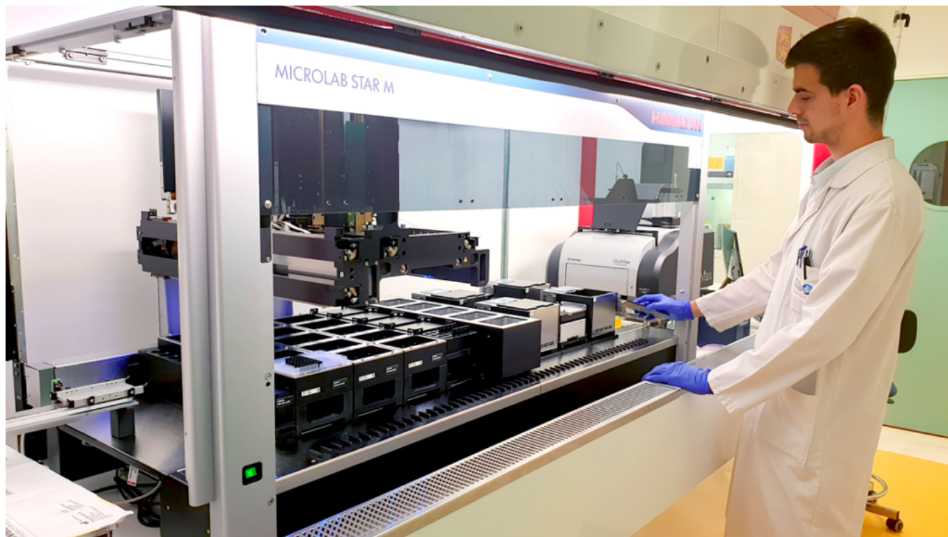
Robot de culture et de traitements de tumeurs conçu à façon en partenariat avec Hamilton pour la plateforme ORGAPRED (US PLATON, Université de Caen Normandie). (©Hermeline Delepoue (Centre François Baclesse)).
